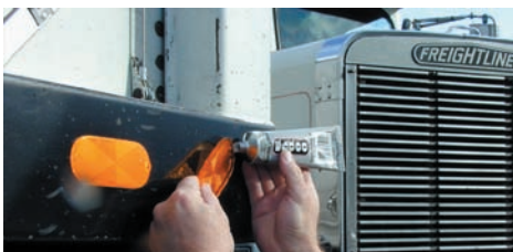
Instalar reflectores de seguridad.
