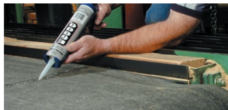
Sellar y reparar cintas transportadoras.
