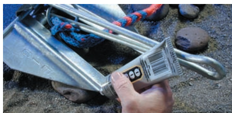
Recubrir y proteger las anclas contra la corrosión.
