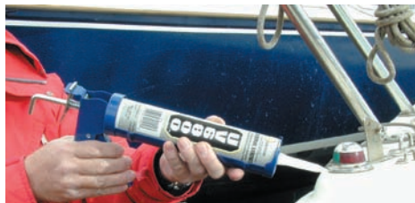
Sellar portillas contra la humedad.
