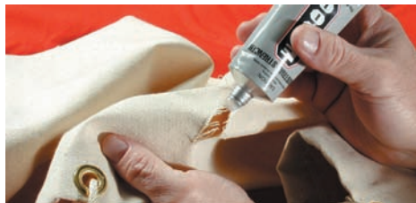
Reparar velas de lona rasgadas y toldos de cubierta rasgados para botes.
